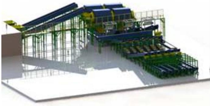
**Fig. 1:** Planta de separación de residuos sólidos urbanos diseñada por MICRONA-REINTECH en Veracruz, Ver., México,
