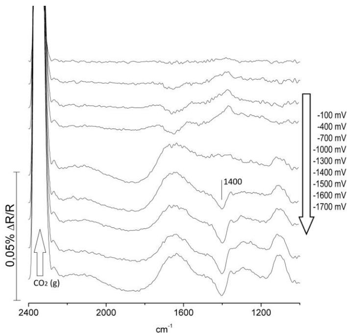
**Figura 13:** Seguimiento de un barrido catódico por FTIR *in situ* de la  $[\text{Fe}^{\text{(II)}}\text{TSFP}]^{\circ} 1 \times 10^{-3} \text{ mol/dm}^{-3}$  en presencia de  $\text{CO}_2$  sobre un electrodo de carbón vítreo.
