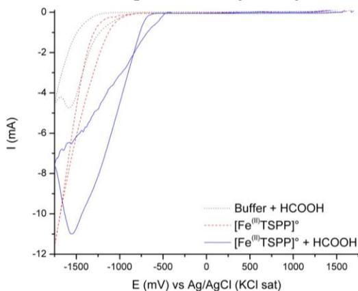
**Figura 4:** Voltamperometría cíclica sobre un electrodo de carbón vítreo a 100 mV/s del medio electrolítico en presencia de HCOOH (puntos) y de la  $[Fe^{(II)}TSFP]^o$  en ausencia de HCOOH (línea punteada) y en presencia de HCOOH (línea sólida)
