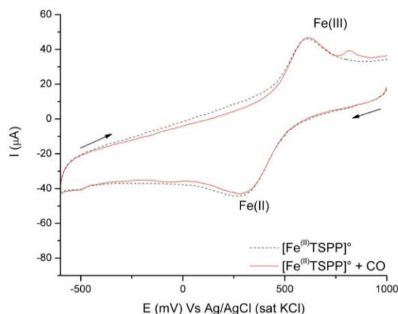
**Figura 2:** Voltamperometría cíclica sobre un electrodo de carbón vítreo a 100 mV/s de la [Fe<sup>(II)</sup>TSFP]  $1 \times 10^{-3}$  mol/dm<sup>3</sup> en presencia de CO (línea sólida) y N<sub>2</sub> (línea punteada).
