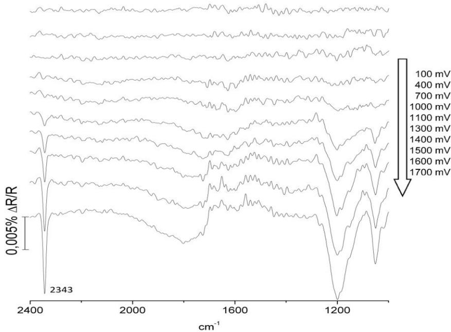
**Figura 6:** Seguimiento de un barrido anódico por FTIR *in situ* de la  $[\text{Fe}^{(III)}\text{TSFP}]$  en presencia de  $\text{HCOOH}$  sobre un electrodo de carbón vítreo
