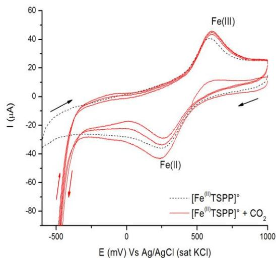
**Figura 12:** Acercamiento de la voltamperometría cíclica (-1700 hasta 1700 mV) sobre un electrodo de carbón vítreo a 100 mV/s de la  $[\text{Fe}^{\text{III}}\text{TSFP}]^{\circ}$  en presencia (●) y en ausencia (--) de CO<sub>2</sub>.
