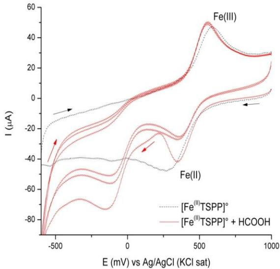
**Figura 5:** Voltamperometría cíclica sobre un electrodo de carbón vítreo a 100 mV/s de la  $[\text{Fe}^{(III)}\text{TSFP}]^0$   $1 \times 10^{-3}$  M en ausencia (--) y en presencia de  $\text{HCOOH}$  (●).
