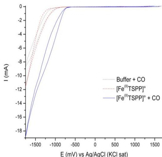
**Figura 1:** Voltamperometría cíclica sobre un electrodo de carbón vítreo a 100 mV/s del medio electrolítico en presencia de CO (puntos) y de la [Fe<sup>(II)</sup>TSFP]<sup>o</sup>  $1 \times 10^{-3}$  mol/dm<sup>3</sup> en presencia de N<sub>2</sub> (línea punteada) y de CO (línea sólida).
