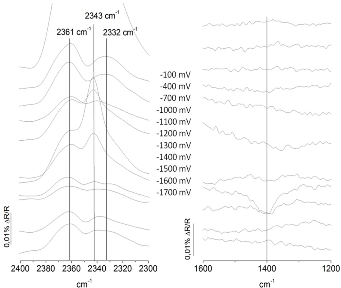
**Figura 14:** Acercamiento de las zonas de interés del barrido catódico por FTIR (NERD) *in situ* de la  $[\text{Fe}^{\text{(II)}}\text{TSFP}]^{\circ} 1 \times 10^{-3} \text{ mol/dm}^{-3}$  en presencia de  $\text{CO}_2$  sobre un electrodo de carbón vítreo.
