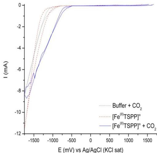
**Figura 11:** Voltamperometría cíclica sobre un electrodo de carbón vítreo a 100 mV/s del medio electrolítico en presencia de CO<sub>2</sub> (puntos) y de la  $[\text{Fe}^{\text{III}}\text{TSFP}]^{\circ}$  en presencia de N<sub>2</sub> (línea punteada) y de CO<sub>2</sub> (línea sólida).
