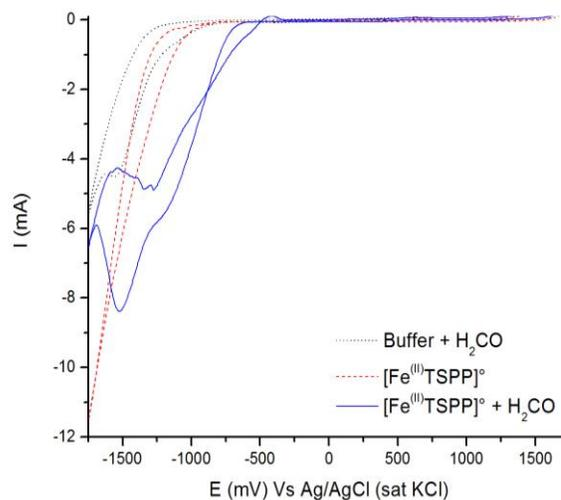
**Figura 7:** Voltamperometría cíclica sobre un electrodo de carbón vítreo a 100 mV/s del medio electrolítico en presencia de  $H_2CO$  (puntos) y de la  $[Fe^{(II)}TSFP]$  en presencia de  $N_2$  (línea punteada) y de  $H_2CO$  (línea sólida).
