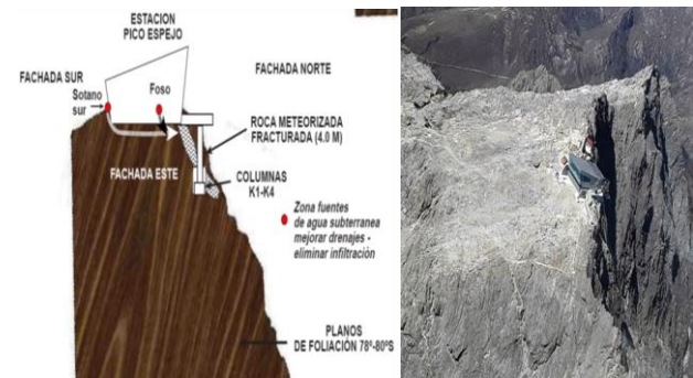
Figura 6. Se muestra la zona de fuente y manantiales de agua subterránea, planos de foliación dominantes y zonas de roca fracturada Las cuales afecta las fundaciones de la estación especialmente K1-K4. Fuente: Fotografía Meridaadventure, 2019.
