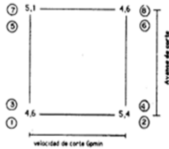
FIG 2 - REPRESENTACION DE DOS FACTORES DE INTERACCION ENTRE LA VELOCIDAD Y EL AVANCE DE CORTE.
