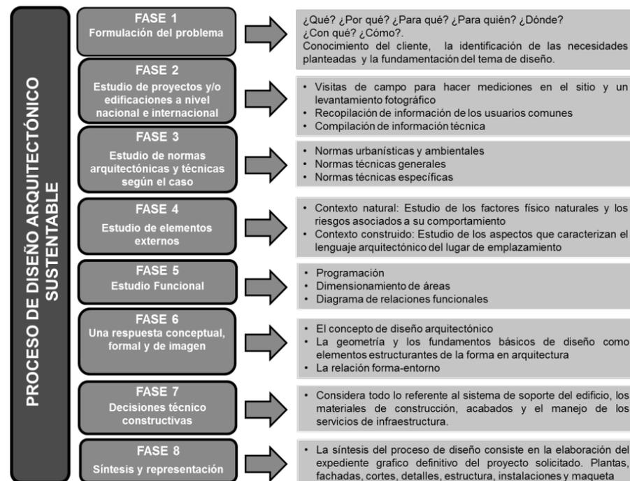
FIG. 10 Proceso de diseño arquitectónico sustentable. ELABORACIÓN PROPIA.
