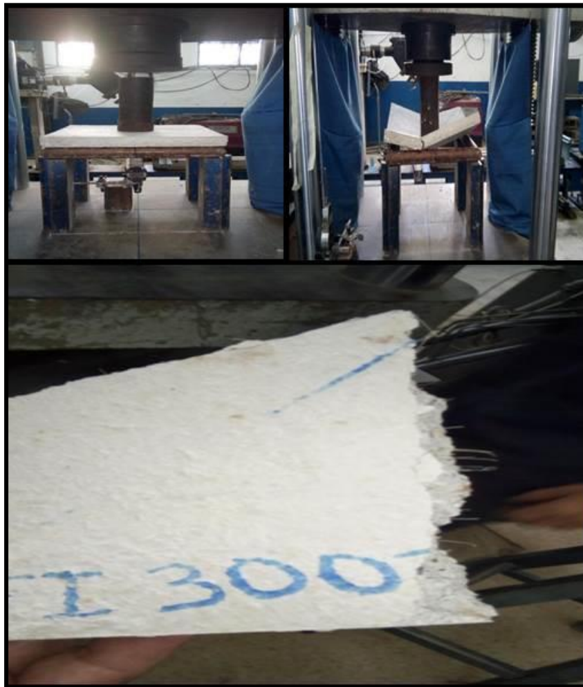
FIGURA 17. Ensayo a Compresión de las Placas con Malla Plástica; muestra final de ensayo a compresión de Placa con Malla Plástica; y restos de placa ensayada con mezcla fibra de Fique.
