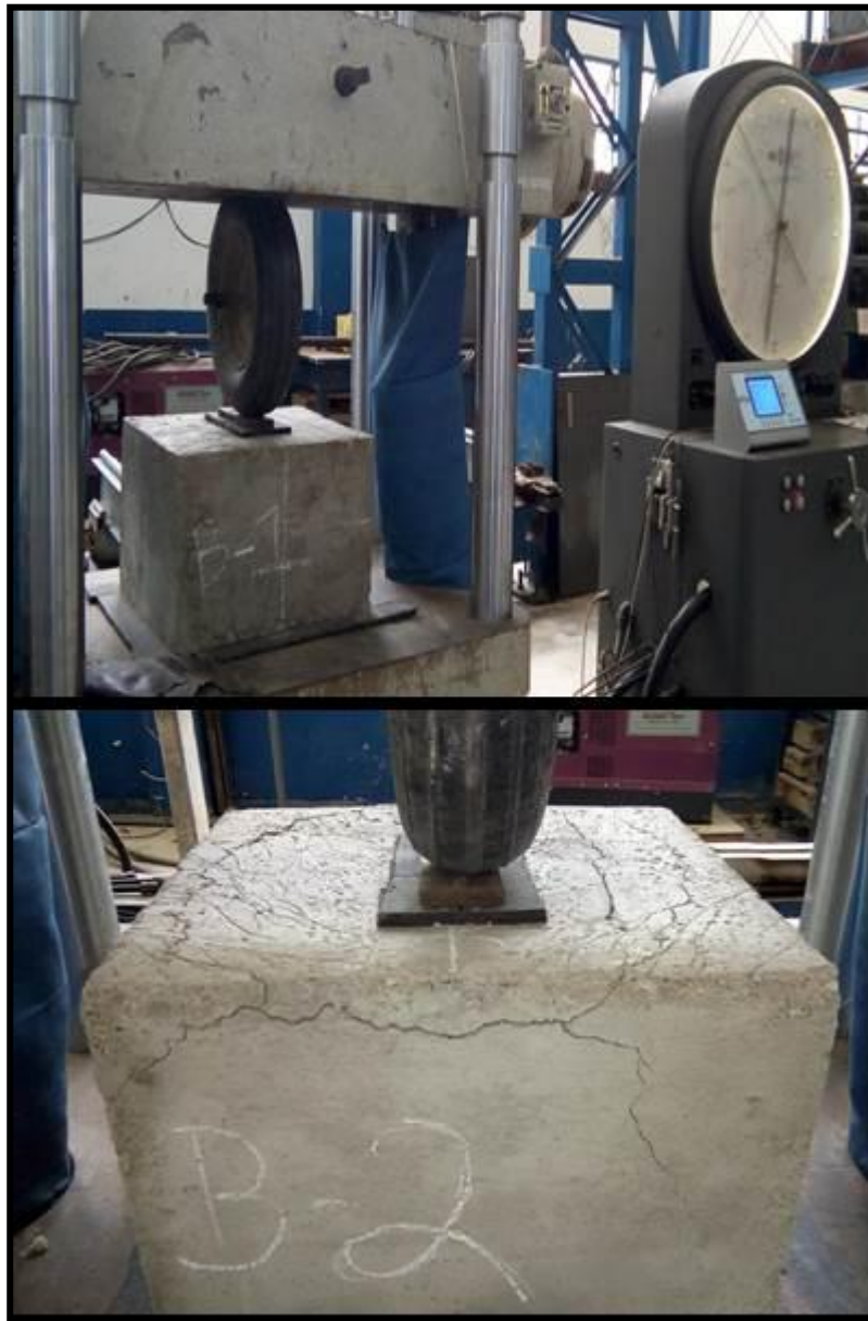
FIGURA 27. Ensayo a Compresión de los bloques tipo Piñata y muestra final ensayo a Compresión.
