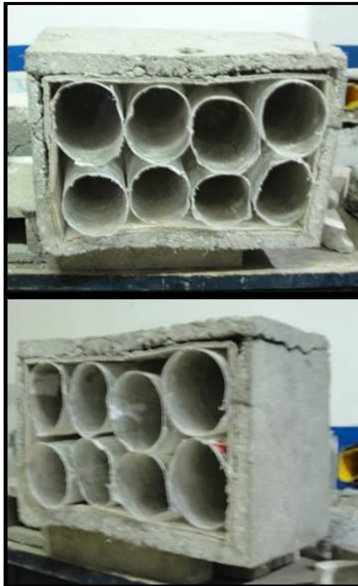
FIGURA 28. Vista de las secciones de uno de los bloques tipo Piñata conformado por botellas de refresco manufacturada con plástico PET después del ensayo a Compresión; se puede apreciar el grosor de la placa que conforma los planos estructurales del mismo y parte de una de las fallas laterales entre.
