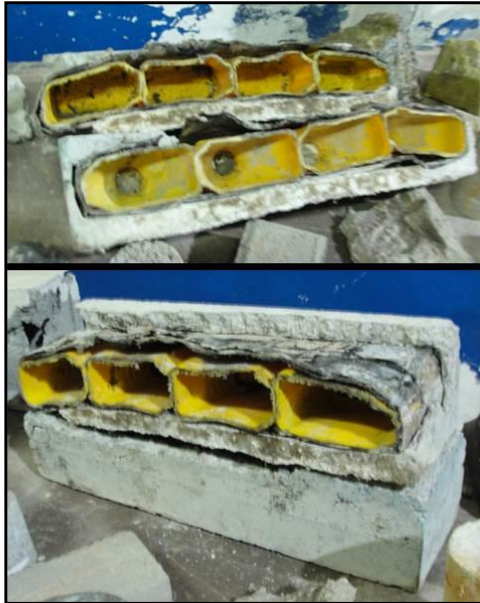
FIGURA 26. Vista de las secciones de uno de los bloques tipo Tabelón elaborado con PEAD después del ensayo a Compresión, donde se puede apreciar el grosor de la placa que conforma los planos estructurales del mismo y la poca deformación de los envases plásticos.
