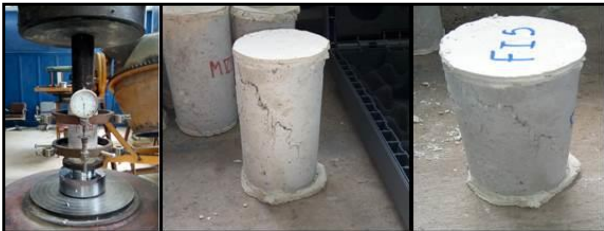
FIGURA 16. Colocado del cilindro en la máquina RIEHLE para rotura de probetas a compresión y la muestra en una de las probetas de cilindro de mortero ensayado a compresión con rotura de 35 grados; y de igual manera la probeta F15 cilindro de mortero con fique ensayado a compresión con rotura de 35 grados. Fuente: Elaboración propia.
