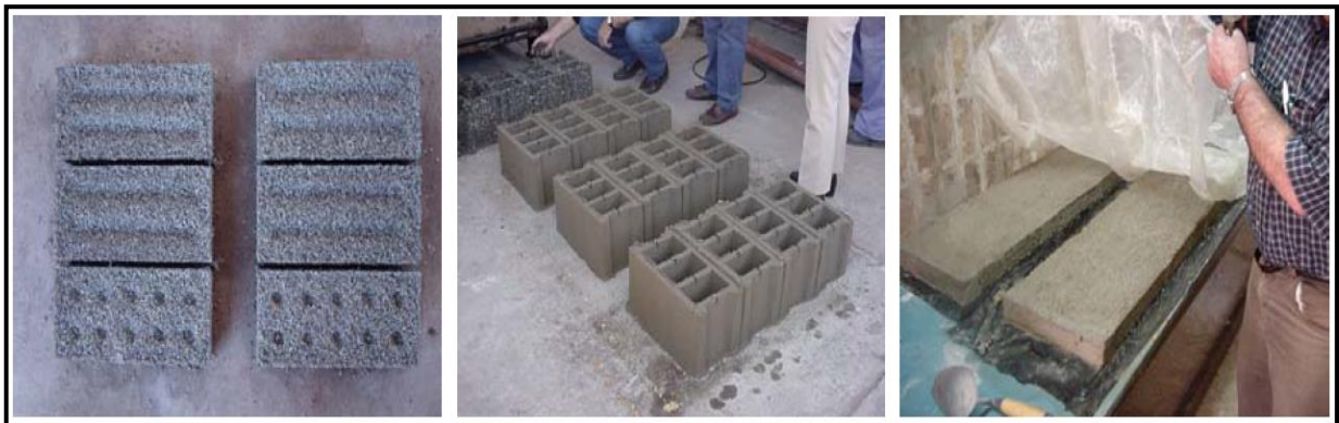
FIGURA 11. Elementos constructivos fabricados con plásticos reciclados. Fuente: Gaggino et al. , 2007.
