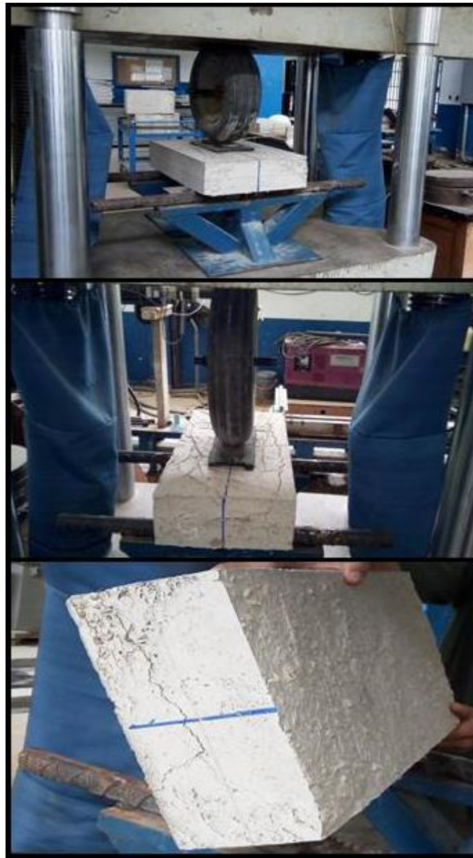
FIGURA 25. Ensayo a compresión de bloques tipo Tabelaón; muestra final del ensayo a compresión; y detalle muestra final ensayo a compresión.
