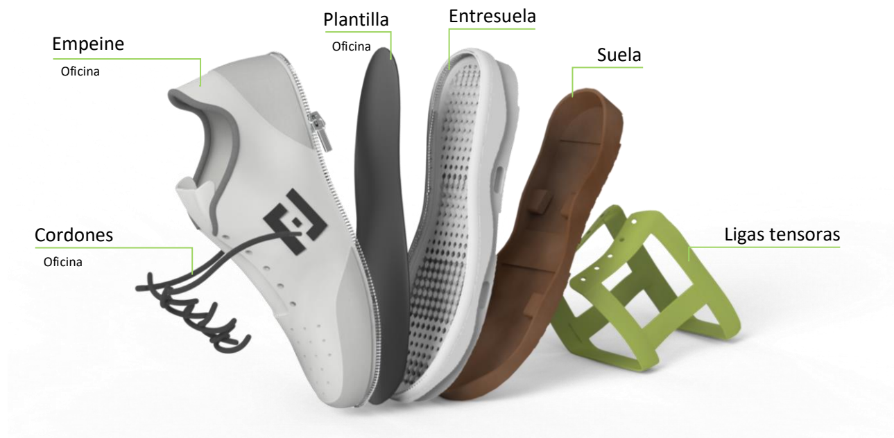
FIGURA 38. Modularidad de las piezas, que se pueden reponer cuando se deterioran. Fuente: Elaboración propia.
