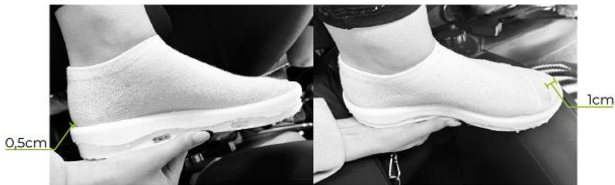
FIGURA 23. Holgura de la suela. Fuente: Elaboración propia.
