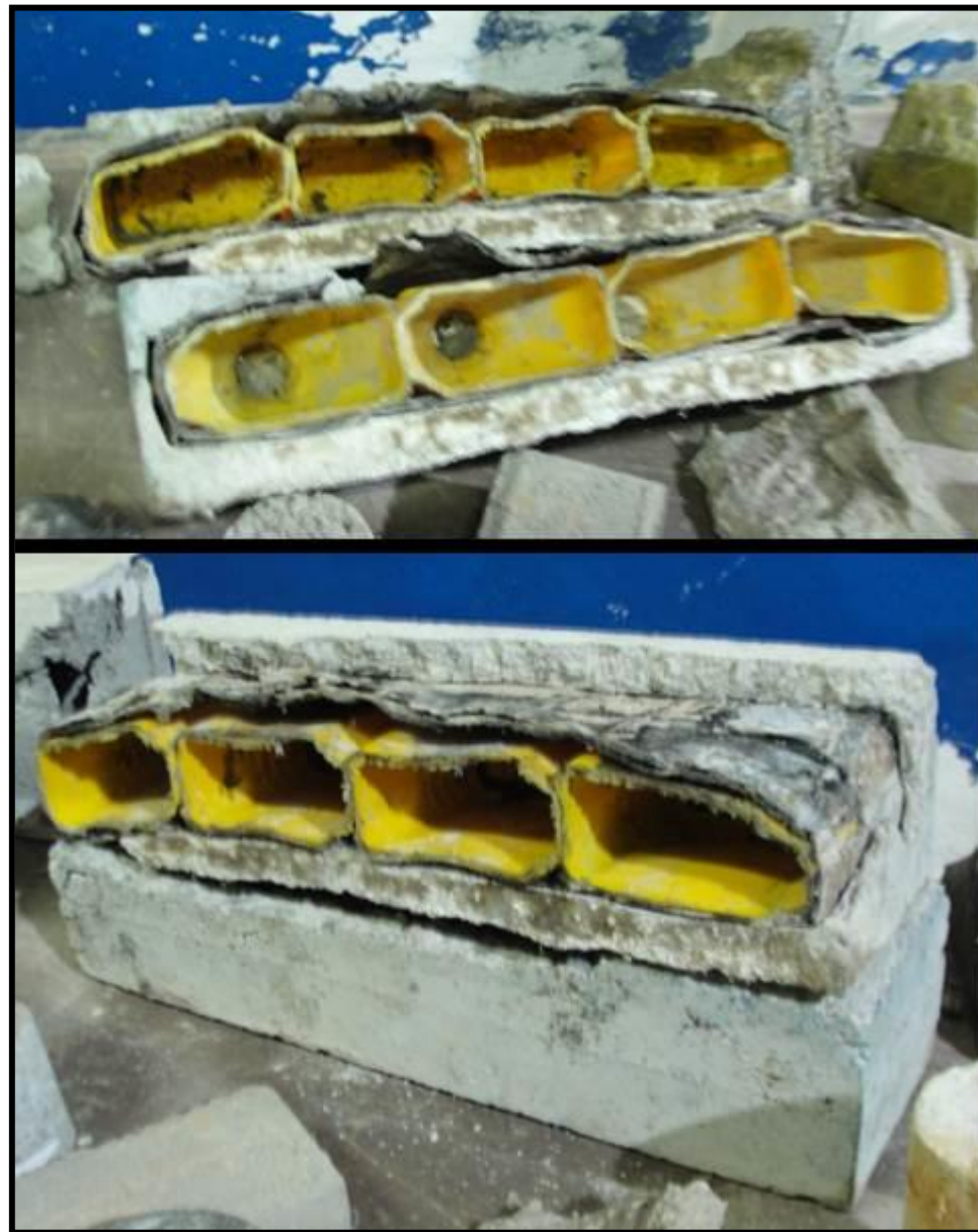
FIGURA 26. Vista de las secciones de uno de los bloques tipo Tabelón elaborado con PEAD después del ensayo a Compresión, donde se puede apreciar el grosor de la placa que conforma los planos estructurales del mismo y la poca deformación de los envases plásticos.
