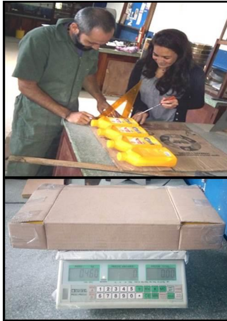
FIGURA 8. Colocación y organización de los envases de PEAD de aceite lubricante para su ensamblaje dentro de las cajas de cartón, con el previo trazado de medidas finales de la caja de cartón para el embalaje y ensamblaje de las botellas de PEAD de aceite lubricante de motor; y finalmente, Pesaje de la caja, ya embalada, de relleno del bloque tipo tabelón. Fuente: Elaboración propia.
