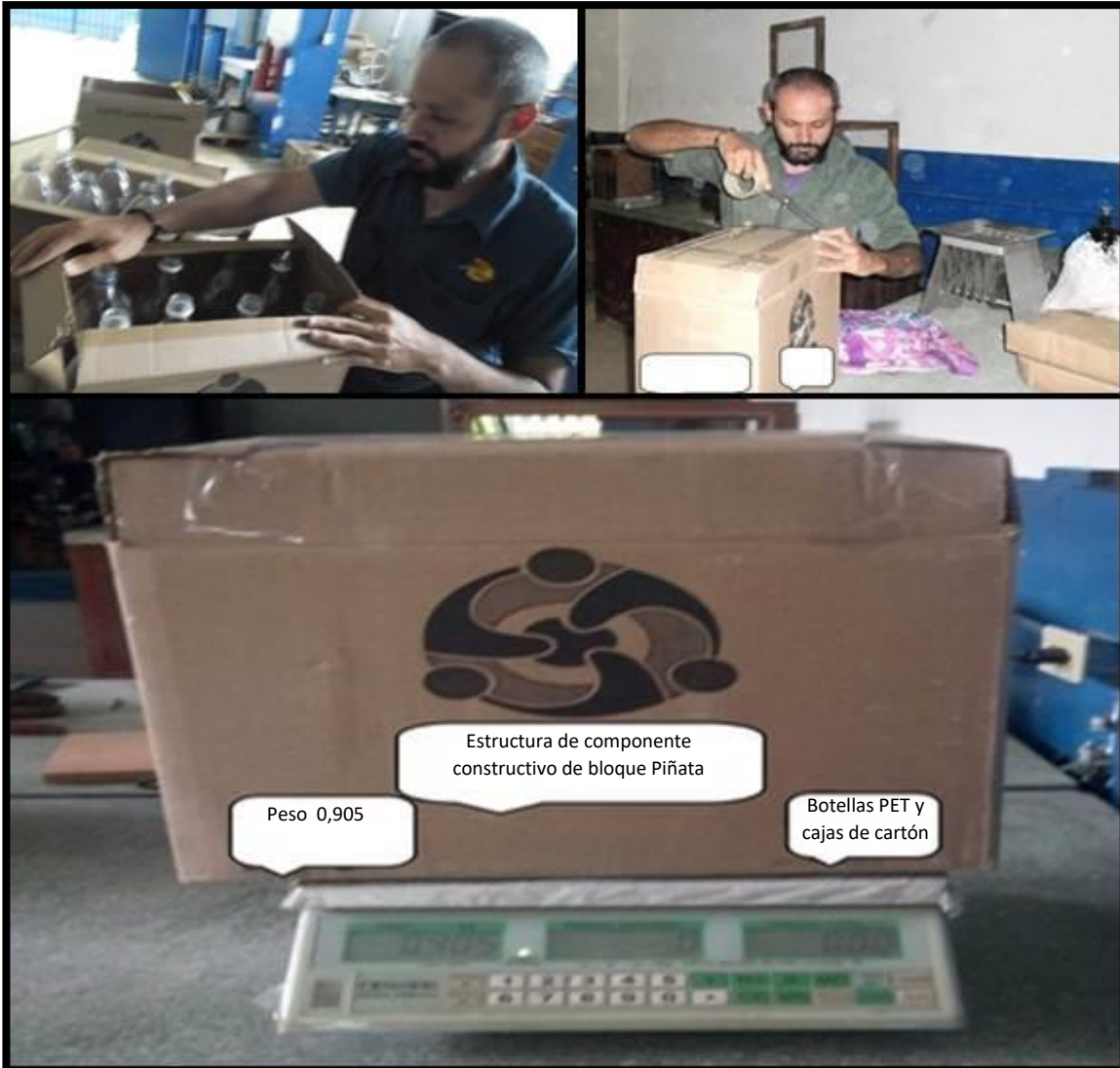
FIGURA 7. Colocación final de las botellas de PET de refresco en la caja de cartón previamente acondicionada; Embalaje de las botellas de PET dentro de las cajas de cartón con cinta plástica de embalar; Pesaje de las cajas de cartón con las botellas de PET incorporadas. Fuente: Elaboración propia.
