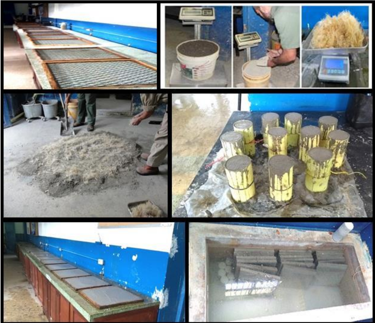
FIGURA 5. Proceso secuencial gráfico que expone las formaletas de madera para desarrollo de placas con refuerzo de malla metálica; el pesaje de los distintos materiales (arena, cemento Portland gris y fibra natural de fique); vertido de los agregados con pala para la elaboración del mortero de arena y cemento reforzado con fibra natural de fique; toma de los cilindros de muestra de cada una de las mezclas de mortero realizadas en el laboratorio; Vaciado y acabado final de las placas de mortero reforzado realizadas en el laboratorio y, por último, en este proceso, el almacenaje y curado de las placas y cilindros de muestra en el tanque especial. Fuente: Elaboración propia.
