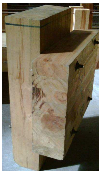
FIGURA 1. Algunas de las probetas de madera laminada de pino caribe para el ensayo de uniones, haciendo uso de barra lisa roscada de \frac{1}{2} ", cizallamiento doble (a) y cizallamiento simple (b). Fuente: Foto propia.
