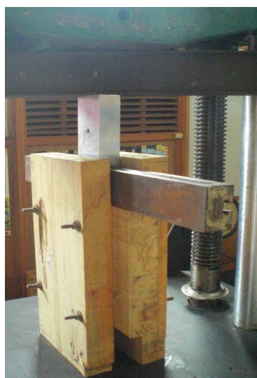
FIGURA 2. Algunas de las probetas de madera laminada de pino caribe al momento del ensayo de uniones, haciendo uso de barra lisa roscada de \frac{3}{8} ", cizallamiento doble (a) y cizallamiento simple (b). Fuente: Foto propia.
