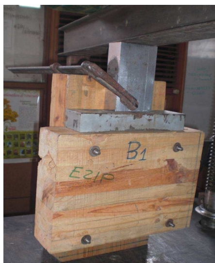
FIGURA 2. Algunas de las probetas de madera laminada de pino caribe al momento del ensayo de uniones, haciendo uso de barra lisa roscada de \frac{3}{8} ", cizallamiento doble (a) y cizallamiento simple (b). Fuente: Foto propia.
