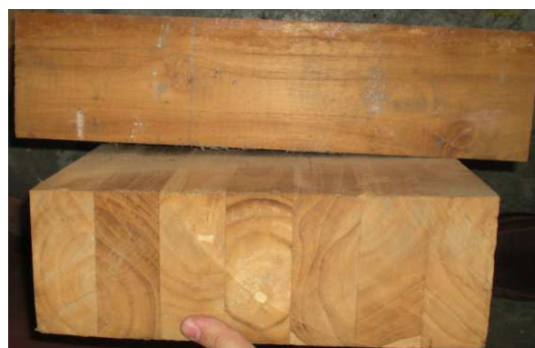
FIGURA 3. Probetas de madera laminada de teca clavadas luego del ensayo, donde se puede apreciar la falla en la unión. Fuente: Foto propia.
