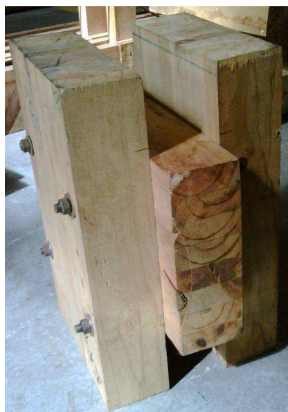
FIGURA 1. Algunas de las probetas de madera laminada de pino caribe para el ensayo de uniones, haciendo uso de barra lisa roscada de \frac{1}{2} ", cizallamiento doble (a) y cizallamiento simple (b). Fuente: Foto propia.
