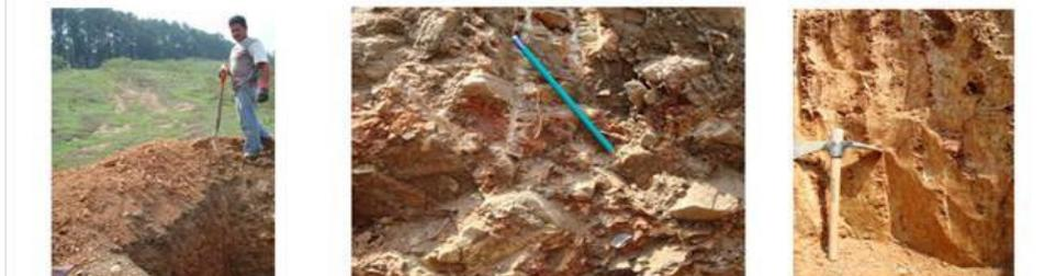
Figura 10. Naturaleza del suelo residual de la Formación Sabaneta. Areno gravosos. (SP-GW). El suelo residual con datos de apoyo en campo se consideró de hasta cuatro metros de espesor
