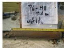
Figura 11. Registro de perforación año 2010. Sector los Tanques, Mérida. Asociación Sierra Nevada. Areno-gravoso. (SW-SG). El suelo residual se presentó hasta los cinco metros de profundidad
