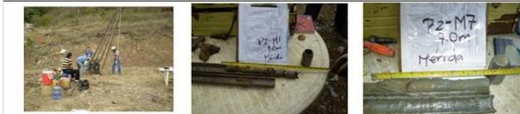
Figura 9. Registro de perforación año 2010. Sector Santa Anita, Mérida. Formación Palmarito. Arcillo-gravoso. (CL-CG).El suelo residual se presentó hasta los cinco metros de profundidad
