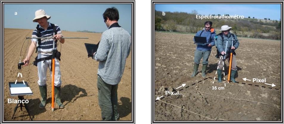
Figura 4. Calibración del objetivo de referencia Spectralon® (a), y medida de reflectancia del suelo con el espectroradiómetro ASD FieldSpec Pro®. (b)
