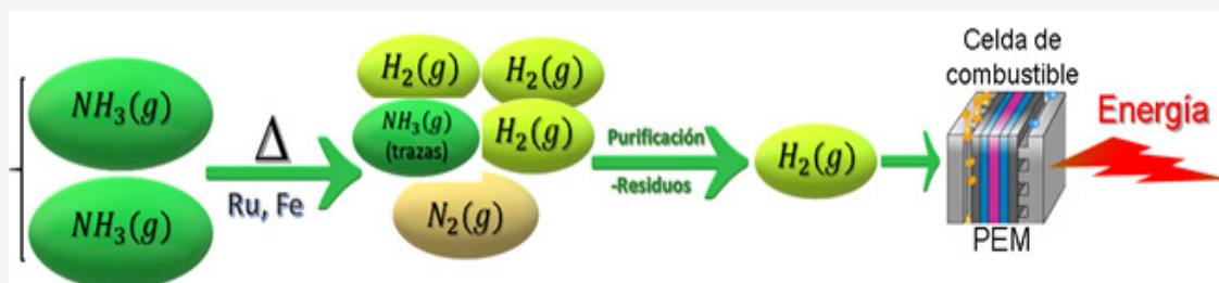
Figura 5. Suministro de hidrógeno verde desde el amoníaco a celdas de combustible 17
